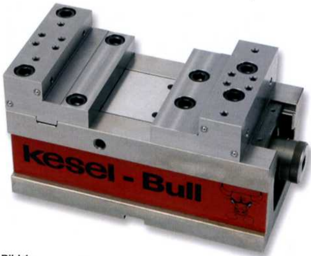
Bild 1: Spannt Werkstücke über ein Gewinde mit bis zu 40 kN bei 105 Nm Anzugsdrehmoment sicher: Der neue mechanische Kompaktspanner Bull 5-S
