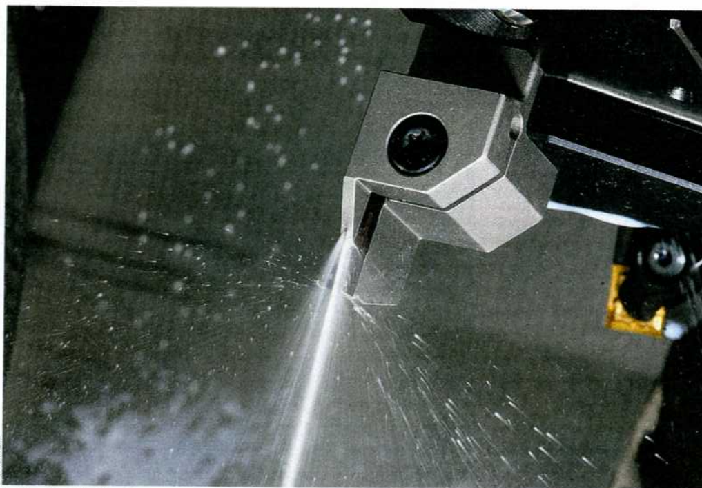
Bei den Stechdrehwerkzeugen Garant eco wird die Kühlflüssigkeit direkt zwischen Schneidkante und Span geleitet.
