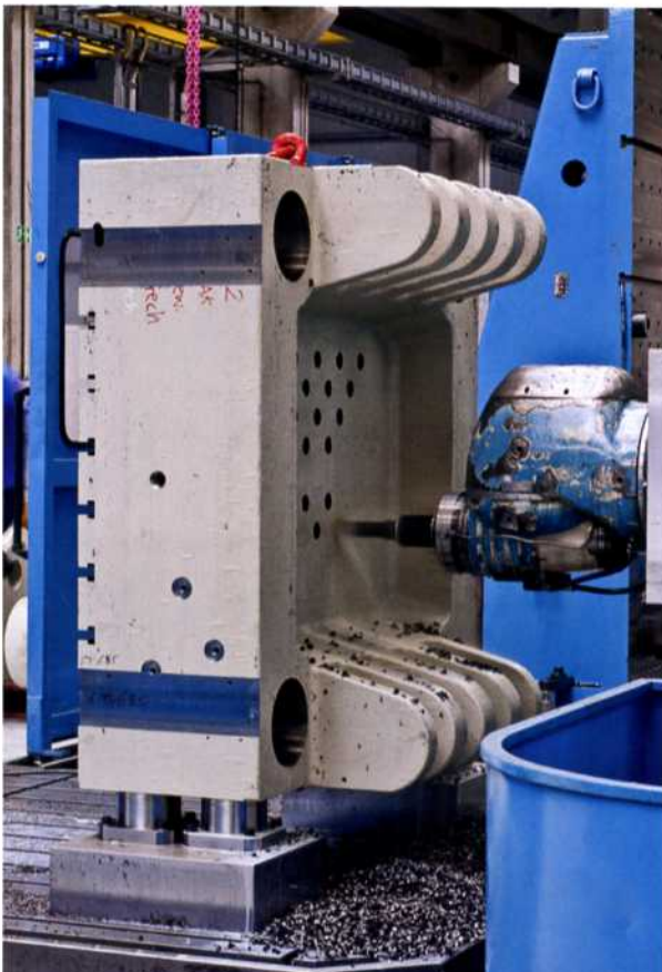
Bild 5: Sicheres Spannen trotz ungünstiger Hebelverhältnisse: Zero-Point-Spannsystem (Werkbilder: AMF Andreas Maier GmbH & Co. KG, Fellbach)
