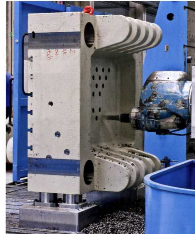
Sicher Spannen trotz ungünstiger Hebelverhältnisse: Zero-Point-Spannsystem
