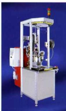
Ein Kammerleck-Testverfahren der **Zeltwanger Automation GmbH** ist für die automatisierte Dichtheitsprüfung von Teilen mit komplexen Geometrien und hohen Anforderungen an die Dichtheit vorgesehen. Das Helium-Akkumulationsverfahren kommt ohne Vakuum aus und ermittelt dennoch kleinste Leckagen nahezu unabhängig von den Umgebungseinflüssen. Das modulare, kompakte Anlagenkonzept mit automatisierter Belademöglichkeit und kurzen Takt-
