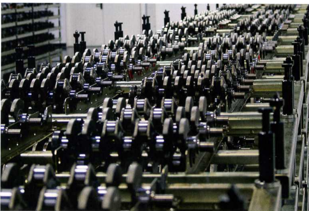
Feuer Powertrain GmbH setzt auf Flexibilität und fertigt vollautomatisiert bis zu 1 800 Kurbelwellen täglich.
