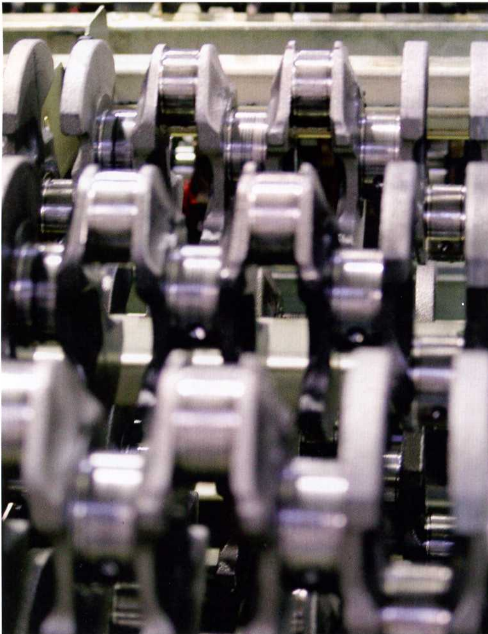
In der Fertigung von Feuer Powertrain werden die Kurbelwellen mit Greifertechnik von Röhm transportiert.
