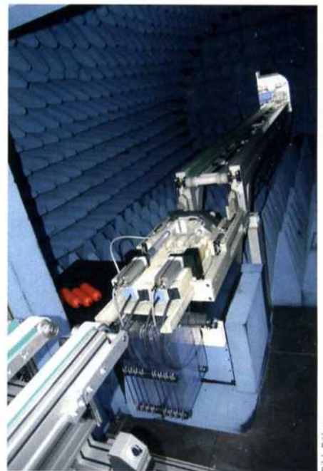
Bild 4: Blick in die begehbare Absorberkammer. In der Bildmitte die Spannvorrichtung in abgesenktem Zustand.
