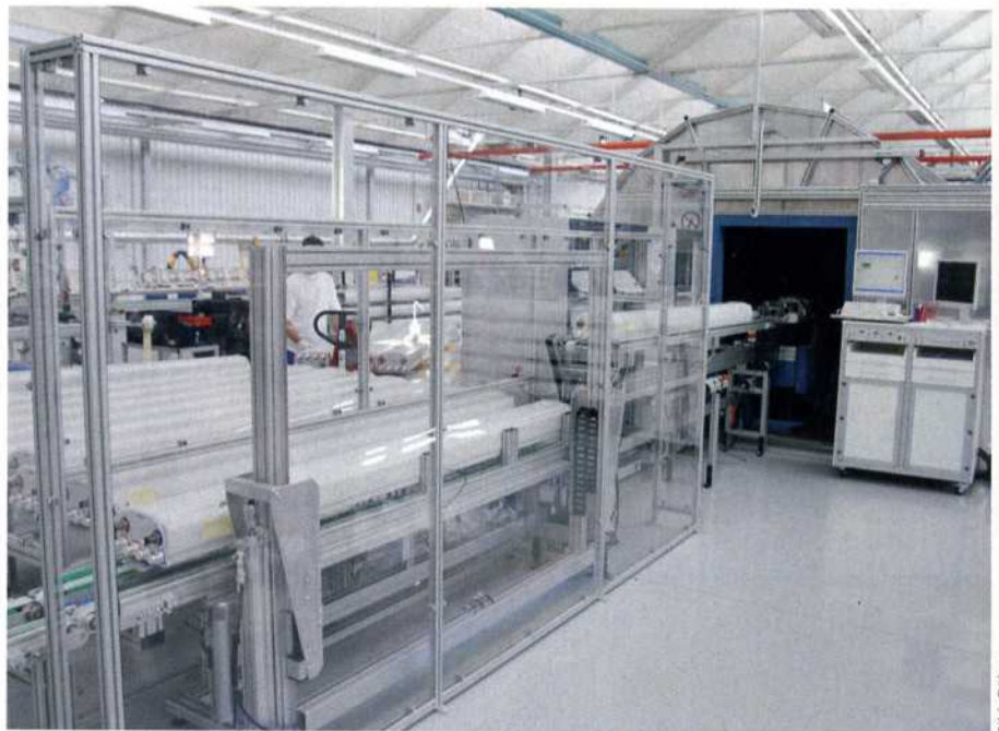
Bild 3: Erster automatischer Messplatz für Mobilfunkantennen bei Kathrein mit Zuführung und Ausschleusung.
