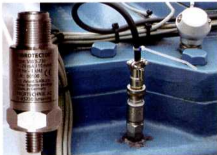
Der Schwingungswächter erlaubt eine normgerechte Online-Überwachung
