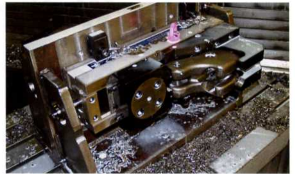
Dank der Aufspannvorrichtung von Röhm sank die reine Bearbeitungszeit eines Werkstücks von 54 auf 36 min.
