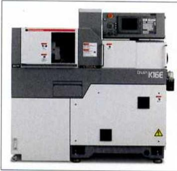
der K- als auch der L-Baureihe. Die Stärken der K-Serie liegen in der Fertigung hochpräziser Teile in kleinen bis mittleren Losgrößen. Bei der K12-Evolution beträgt der Durchmesser bis 12 mm, bei der K16-Evolution bis 16 mm. Für eine möglichst wirtschaftliche Fertigung wurden bei den Evolution-Modellen die Rüstzeiten verkürzt, Achsverzögerungen und -
