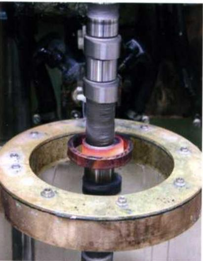
Die HWG Inductoheat ist ein innovativer Spezialist rund um die Prozesse des Induktionshärtens. So hat das Unternehmen jüngst nicht nur eine Lösung für das induktive Härten von Schrauben als Schüttgut umgesetzt, sondern erstmals auch unmöglich scheinende Anforderungen zum automatisierten Härten von PKW-Einzelnocken in einer Anlage realisiert. Zudem hat HWG Inductoheat einen Umrichter mit stufenloser Frequenzeinstellung im Programm. Mit Statitron IFP lässt sich ein Werkstück unter
