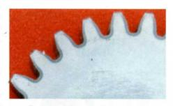
Durch stufenlos einstellbare Frequenzen lassen sich mit nur einem Induktor unterschiedliche Randhärtetiefen realisieren Bild: HWG Inductoheat
