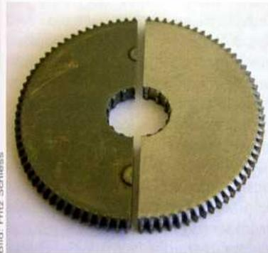
Durch das neue RE-Verfahren der Fritz Schiess AG erhöht sich der Traganteil der Zähne von herkömmlichen 60 bis 70% (links) auf rund 90% der Fläche (rechts). Damit lassen sich nicht nur Montageschritte sondern auch Material einsparen.
