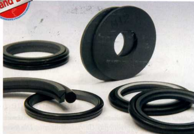
Der neue Hightech-Werkstoff auf PTFE-Basis verfügt über universelle Einsatzmöglichkeiten im Hydraulikbereich. Die Grenzen sind -40 bis 200°C, 50 MPa und 15 m/s.
