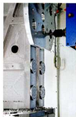
Oberflächengüte: das Spannsystem schluckt Vibrationen.
