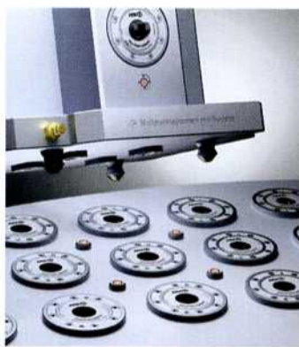
Das AMF-Nullpunktspannsystem Zero-Point senkt die Rüstzeiten.
