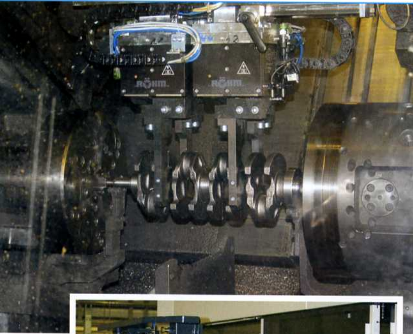
Bild 8: Die Fertigung der Kurbelwellen läuft vollautomatisiert im Mehrschichtbetrieb ab. Über Ladeportale werden die Werkstücke von einer zur nächsten Maschine transportiert
