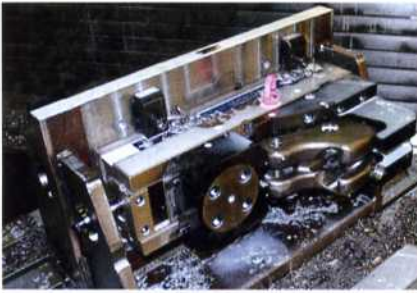
Für die Aufspannung hat Röhms zwei Spannvorrichtungen entwickelt, die auf einem Aufspann-Winkelmodul angebracht werden.
