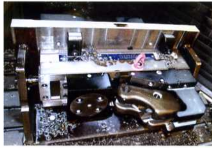
Mit der Spannvorrichtung von Röhms hat sich die reine Bearbeitungszeit eines Werkstückes von 54 auf 36 min und damit um 33 Prozent reduziert.
