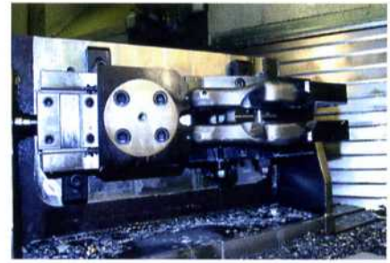
Die Seitenlage hat sich bei RUD als ideale Lösung für die komplizierten Fräs- und Bohroperationen ergeben.
