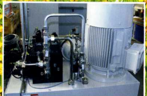
Bei Mehretagenanlagen muss bis zu 300 kN Presskraft aufgebracht werden. Die Hydraulik von Bott arbeitet im Abschaltbetrieb ohne Regelkreis.
