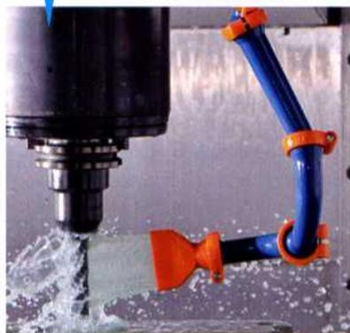
Diese Kühlschmierstoffzuführung befindet sich an einer Frässpindel, aufgebaut aus zwei Stück 90°-Schlauchbogen und einer Schwalldüse.
