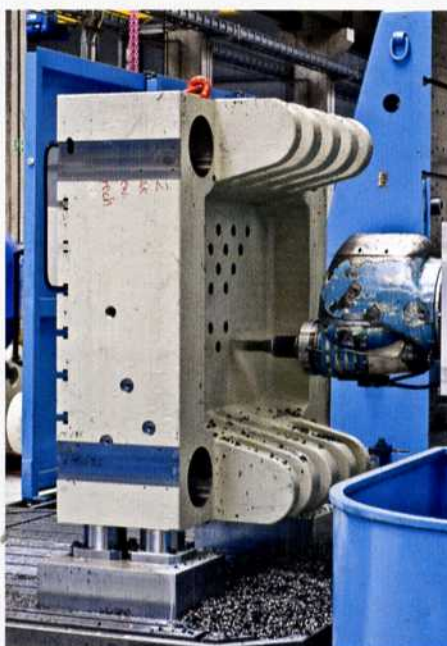
Sicheres Spannen trotz ungünstiger Hebelverhältnisse: Zero-Point-Spannsystem von AMF
