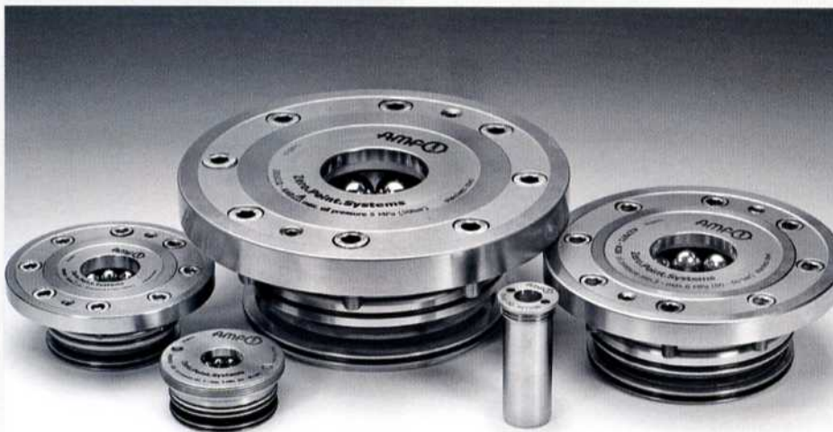
Durchgängig für die Bearbeitung sowohl von Großteilen als auch von Kleinteilen geeignet dank gleicher Schnittstelle: AMF Zero-Point-Universal-Spannmodule mit Haltekraften von 55 kN (rechts) und Schwerlast-Spannmodule mit bis zu 105 kN Haltekraft (links)
