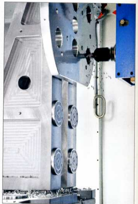
Ergebnis einer Studie: Die Oberflächengüte von Teilen, die mit dem Zero-Point-System gespannt werden ist höher, denn das Spannsystem schluckt Vibrationen
