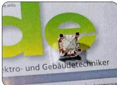
**Bild 15: Die Rückseite des Steckers: der pyramidenförmige Separator**
