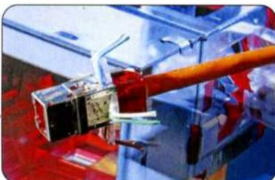
**Bild 16: Die Adern werden beim Zuklappen der Schutzdeckel mittels einer integrierten Klinge abgeschnitten**
