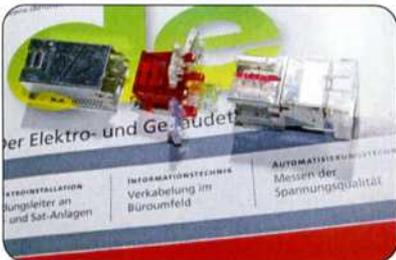
**Bild 14: Der Cat-6A-Stecker von Reichle & De Massari besteht aus drei Teilen**
