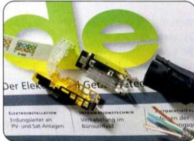
**Bild 13: Stecker von Harting, das Gehäuse besteht aus zwei Teilen: dem Grundkörper mit klappbarem Adersortierer und einer Blechabdeckung. Eine Schraubklemme sorgt für die Zugentlastung des Kabels**
