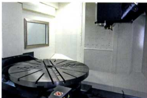
Palettenspanner von Röhm befähigen dieses 5-Achs-Bearbeitungszentrum »DMC 160U duo-Block«, Werkstücke bis 3000 kg Gewicht auf bis zu 1400 mm Durchmesser großen Paletten sicher zu fixieren
