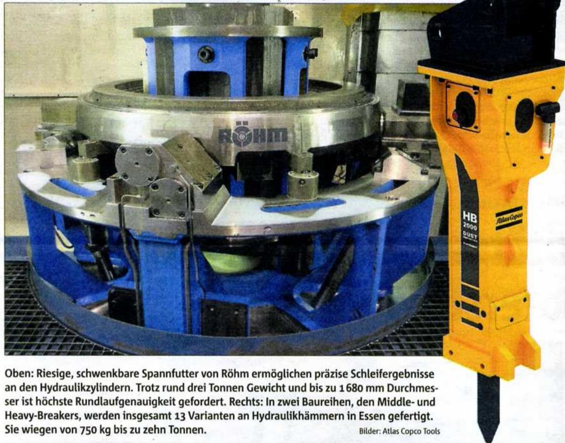
Oben: Riesige, schwenkbare Spannfutter von Röhm ermöglichen präzise Schleifergebnisse an den Hydraulikzylindern. Trotz rund drei Tonnen Gewicht und bis zu 1680 mm Durchmesser ist höchste Rundlaufgenauigkeit gefordert. Rechts: In zwei Baureihen, den Middle- und Heavy-Breakers, werden insgesamt 13 Varianten an Hydraulikhämmern in Essen gefertigt. Sie wiegen von 750 kg bis zu zehn Tonnen.
