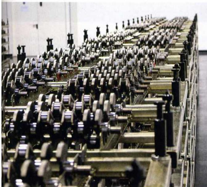
**Feuer Powertrain GmbH & Co. KG setzt auf Flexibilität und fertigt vollautomatisiert bis zu 1.800 Kurbelwellen täglich.**
