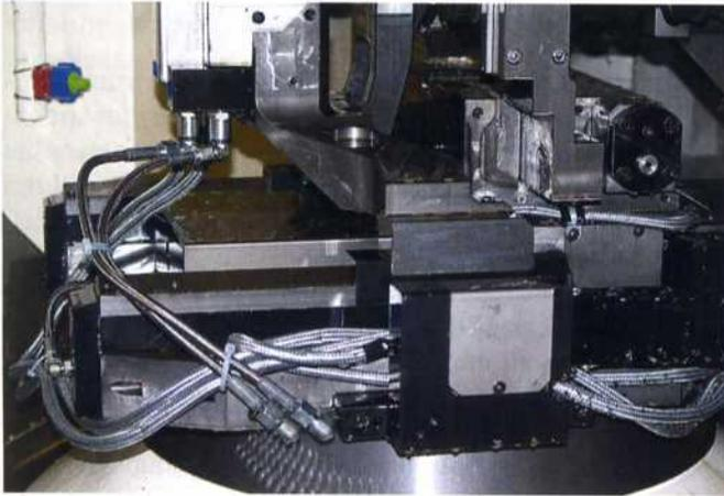
Dank der Röhmvorrichtung mit zwei integrierten NC-Achsen konnte für das Tieflochbohren bei Kurbelwellen eine Standardmaschine verwendet werden.
