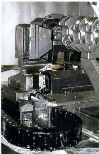
Um den rauen Bedingungen im Bearbeitungszentrum zu widerstehen, sind die elektrischen Aggregate an der Spannvorrichtung für die Schutzklasse IP67 ausgelegt.
