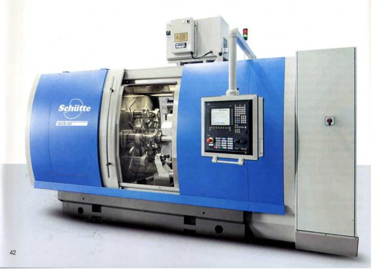
machen das Umrüsten zwischen unterschiedlichen Einstellungen einfacher. Darüber hinaus ermöglicht das patentierte Schütte-Prinzip der dezentralen Antriebsregler für die Hauptspindeln mit integriertem Motor das endlose Durchtakten der Trommel und minimiert somit Verschleiß und Störanfälligkeit.
