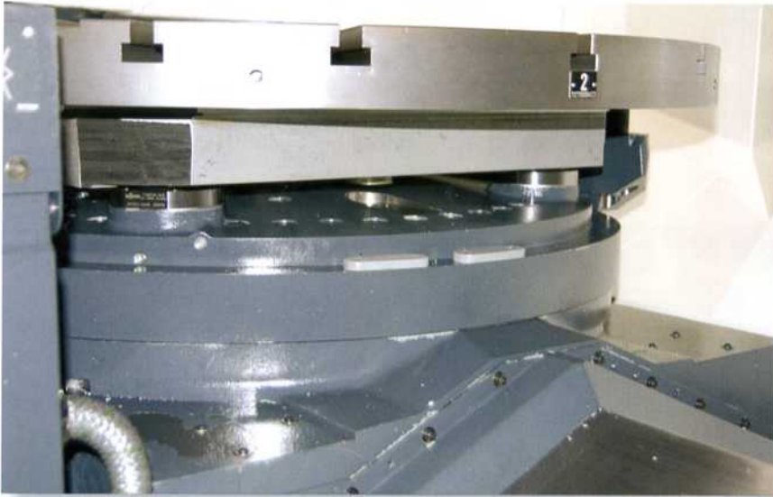
Bild 5: Die Palette wird immer 3-achsig positioniert. Das sorgt für guten Planlauf von 0,01 mm
