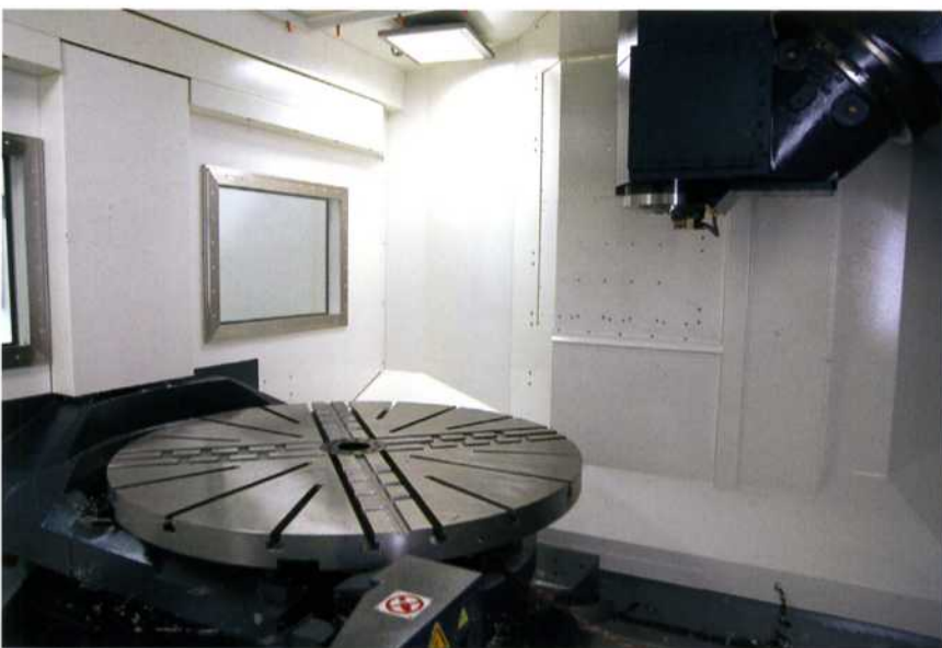
Bild 6: Beim 5-Achsen-Bearbeitungszentrum DMC 160U duoBlock® können Werkstücke bis 3.000 kg auf bis zu 1.400 mm Durchmesser großen Paletten sicher gespannt werden (Werkbilder: Röhm, Sontheim/Deckel Maho GmbH, Pfronten)
