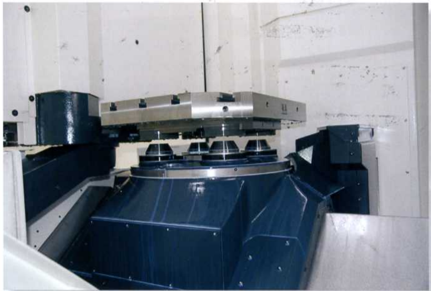
Bild 3: Die Palette wird immer horizontal und zentrisch positioniert, weil die Spannkonen sich die Anzugsbolzen der Palette regelrecht greifen und in die Kegel hineinziehen
