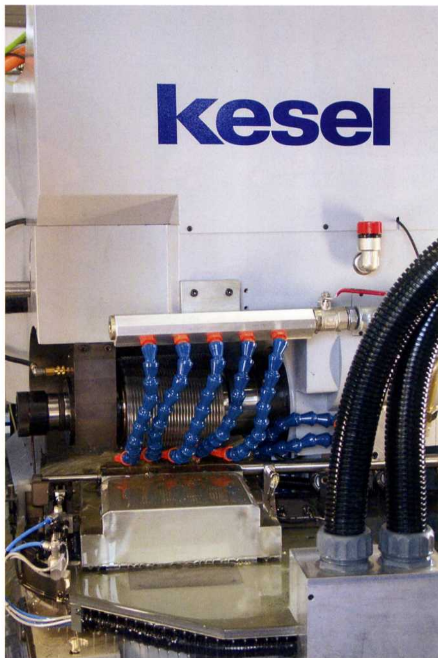
Bild 4: Die Maschine erreicht eine solche Genauigkeit und Oberflächengüte, dass die Lenkverzahnungen nach dem Fräsen in der Endverzahnung vorliegen (Werkbilder: Georg Kesel GmbH & Co. KG, Kempten)
