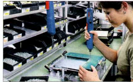
Der Sechsen-Newtonmeter-Schrauber C-Exact 6-600 mit 550 Umdrehungen pro Minute trägt den Anforderungen an die sanfte Verschraubung bei empfindlichen Materialien Rechnung. Bild: Bosch
