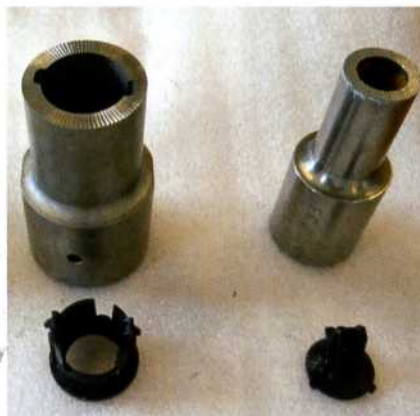
Die Sonotroden bringen mit einer Frequenz von 20 kHz und einer Amplitude bis zu 80 µm in sehr kurzer Zeit große Energie in die Grenzfläche der zu fügenden Teile ein.
