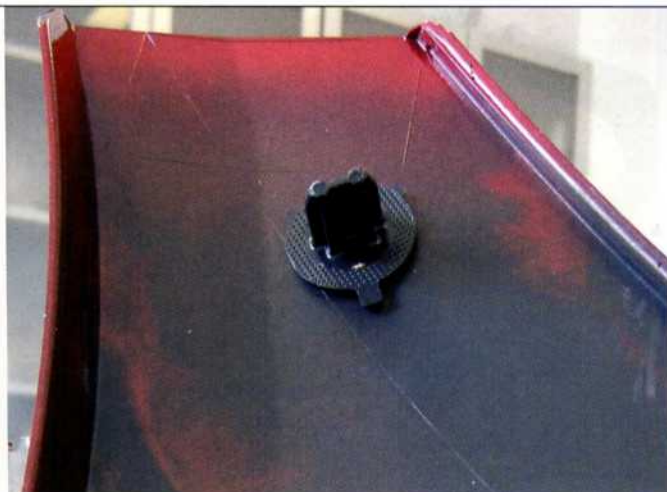
Die zu verschweißen- den Teile, wie hier ein Fixierpin, können ohne zusätzliche Maßnahmen zur Gestaltung der Füge- fläche konstruiert werden.
