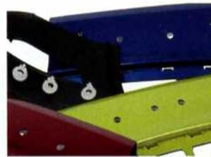
Telsonic hat mit Soniqtwist ein torsionales Ultraschallschweißverfahren entwickelt, das sich zum Fügen von Kunststoffteilen für Zusatzfunktionen an lackierten Exterieurteilen im Automobilbau eignet. Dabei werden Abzugsfestigkeiten bis
