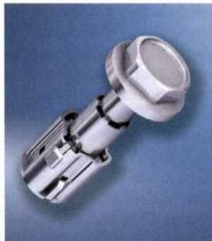
Ejot hat mit der Tensiotec „teleskop“ eine Teleskop-Stützhülse entwickelt, die aufgrund der speziellen Auslegung eine Flanschdicke ermöglicht, die kleiner als die Einschraubtiefe der Schraube ist. Dabei wird die Kombination aus Schraube und Hülse in die Bohrung des Bauteils eingebracht und hält sich durch Kraftschluss in der Bohrung. Formele-
