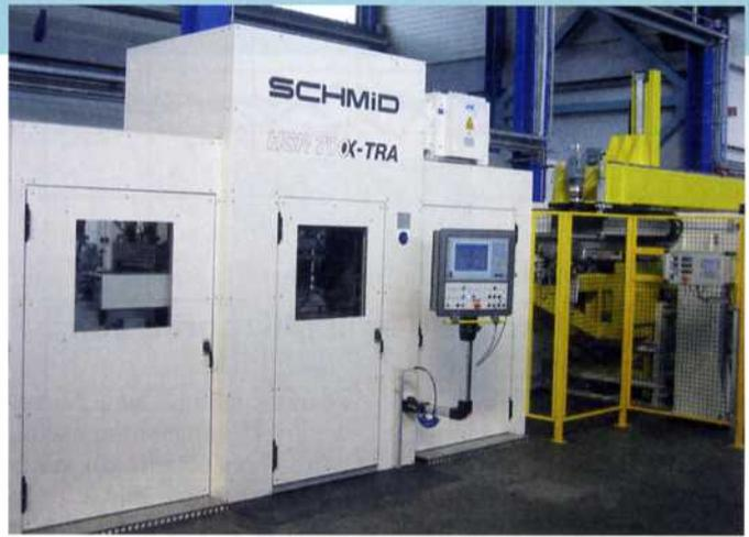
700-t-Feinschneidpresse für Brasilien: Die Neuentwicklung verfügt über einen bewährten Servoantrieb, mit dem Teile bis 17 mm schnell und ohne Schnittschlag feingestanzt werden können. Bild: Schmid
