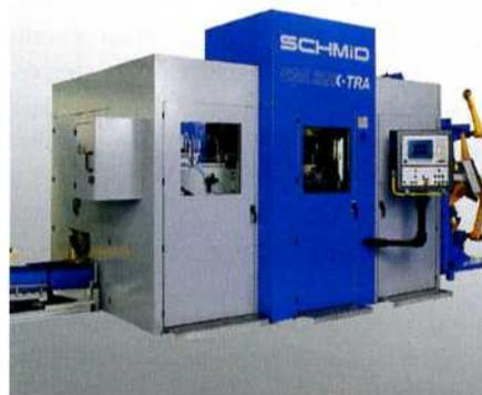
Die neue Presse führt 95 % der Energie ins System zurück. Zum niedrigen Energieverbrauch kommen Vorteile wie variable Zyklusparameter, verbesserte Teilequalität und längere Werkzeugstandzeiten.
