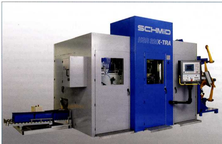
HSR 320 X-TRA mit energieeffizienter Ringzackenbeschaltung, die 95 % der Energie ins System zurückführt. Zum niedrigen Energieverbrauch kommen weitere Vorteile wie variable Zyklusparameter, verbesserte Teilequalität sowie längere Werkzeugstandzeiten. (Bild: Schmid)
