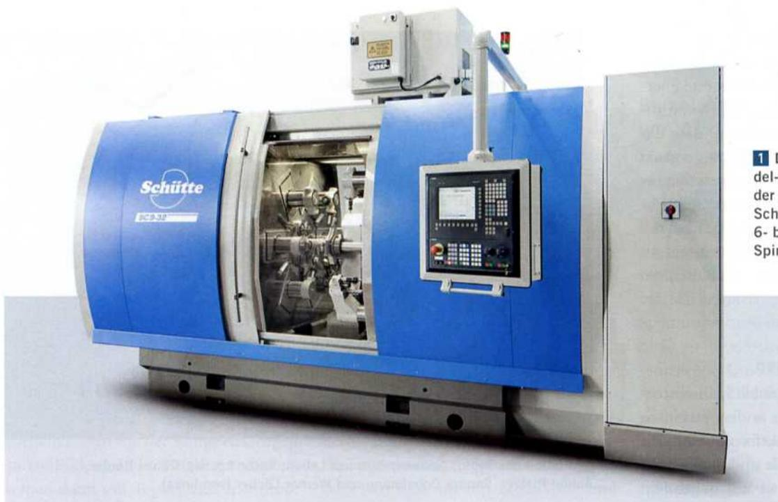
**1** Die Mehrspindel-Drehautomaten der SCX-Reihe von Schütte gibt es in 6- bis hin zu 9-Spindel-Varianten
