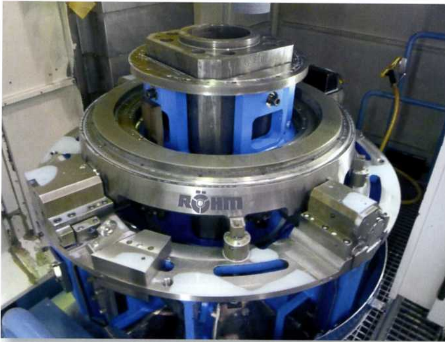
Bild 2: Schwenk-Spannfutter. Erkennbar sind Werkstück, Spannkorb, innerer Schwenk-ring und Futterkörper (von oben nach unten)
