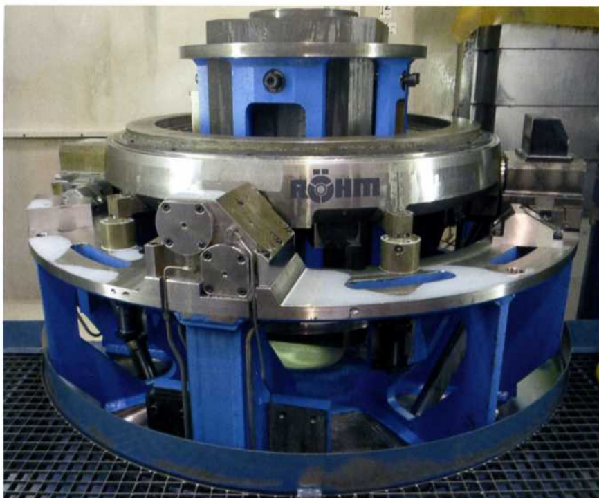
Bild 1: Riesige, schwenkbare Spannfutter ermöglichen präzise Schleifergebnisse an den Hydraulikzylindern. Trotz rund drei Tonnen Gewicht und bis zu 1.680 Millimeter Durchmesser ist höchste Rundlaufgenauigkeit gefordert
