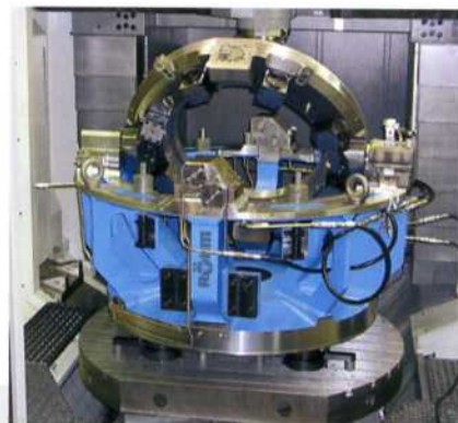
Bild 4: Der Schwenkvorgang muss absolut präzise ablaufen und das Werkstück nach Drehung ohne axialen Versatz neu und exakt positionieren
