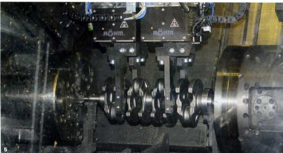
**3** Dank der Röhmvorrichtung mit zwei integrierten NC-Achsen konnte für das Tieflochbohren von Kurbelwellen eine Standardmaschine von Starrag-Heckert verwendet werden.
