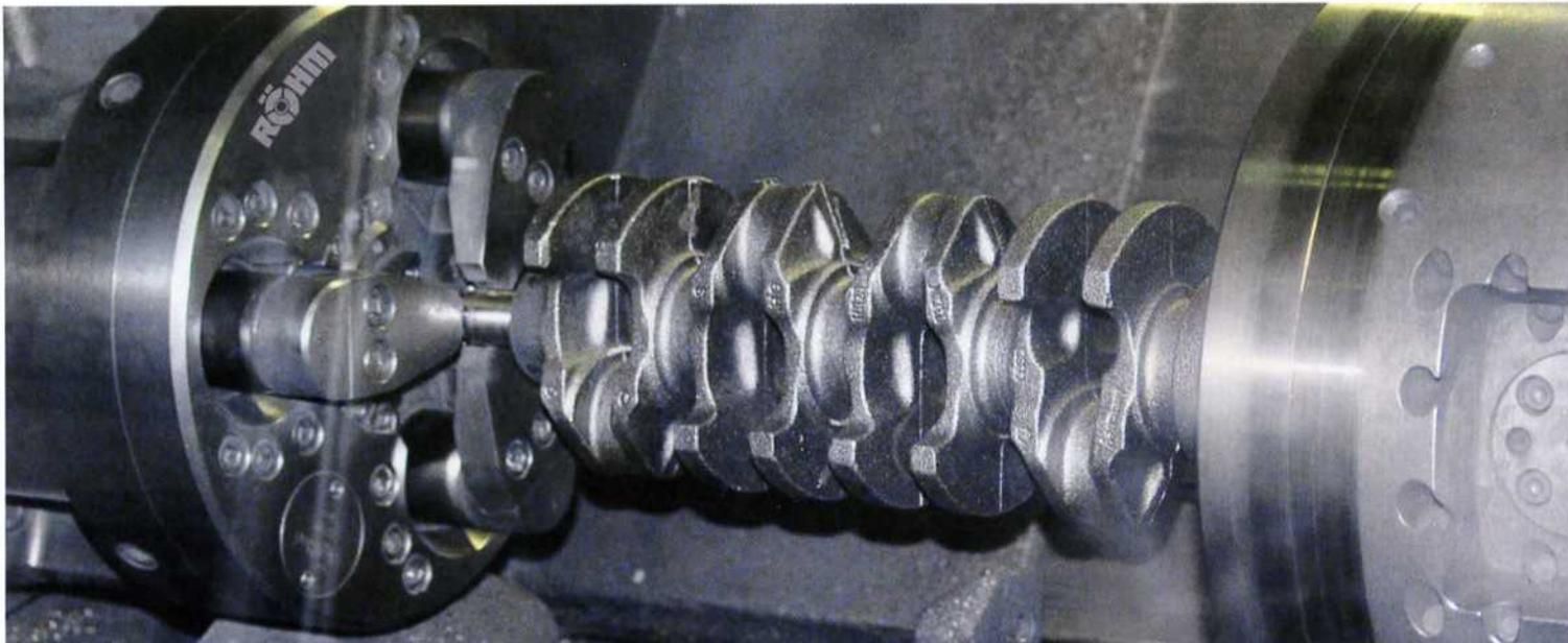
**12 Spannen mit Grips** Kurbelwellen gehören zum Anspruchsvollsten, was Facharbeiterhände erschaffen. Damit es nun diese leichter haben, hat Röhm für die Feuer Powertrain GmbH eine Spannvorrichtung mit NC-Achsen für Standardmaschinen entwickelt.
