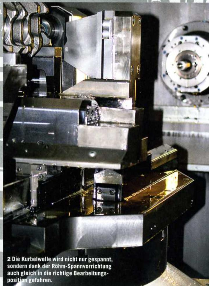
2 Die Kurbelwelle wird nicht nur gespannt, sondern dank der Röhm-Spannvorrichtung auch gleich in die richtige Bearbeitungsposition gefahren.
