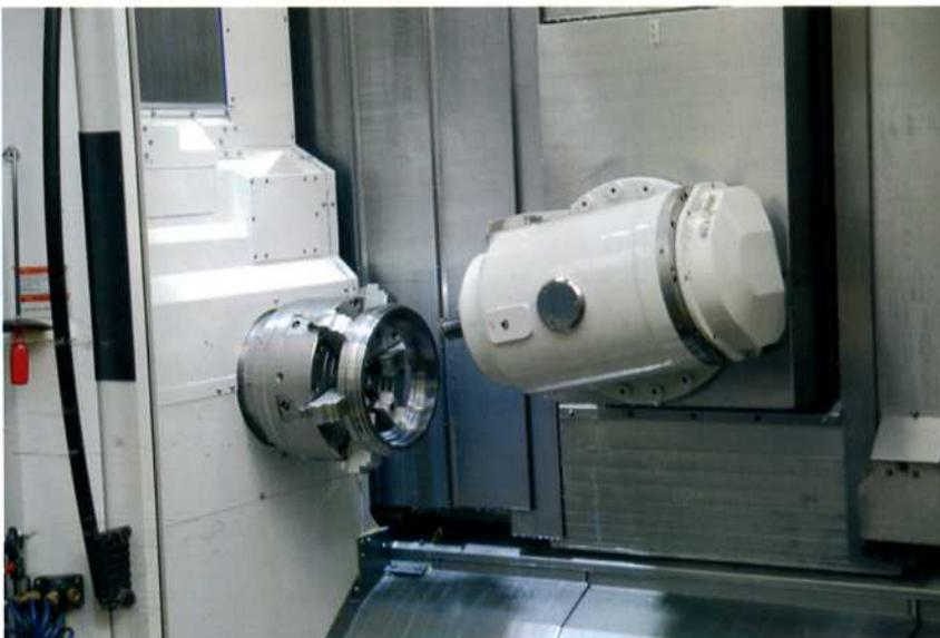
**Bild 5:** Neben der Auswahl geeigneter Werkstoffe erfordern metallische Gleitringdichtungen absolut präzise, maßgenaue Fertigung auf Hochleistungs-Bearbeitungszentren
