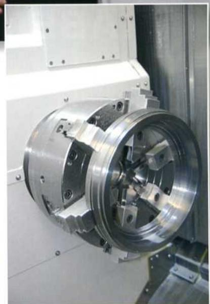
**Bild 2:** Die dünnwandigen und leicht verformbaren Werkstücke werden bei Eagle-Burgmann sicher und formstabil gespannt dank Kraftspannfutter von Röhm
