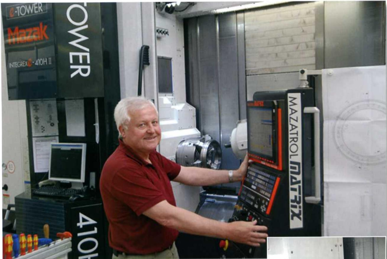
**Bild 1:** Kaspar Rammelmaier zieht ein positives Fazit: „Neben hoher Rundlaufgenauigkeit und großer Wiederholgenauigkeit beeindruckt uns bei den Röhm-Futtern die schnelle und einfache Umrüstung. In drei Minuten ist das Futter für ein anderes Werkstück umgerüstet“
