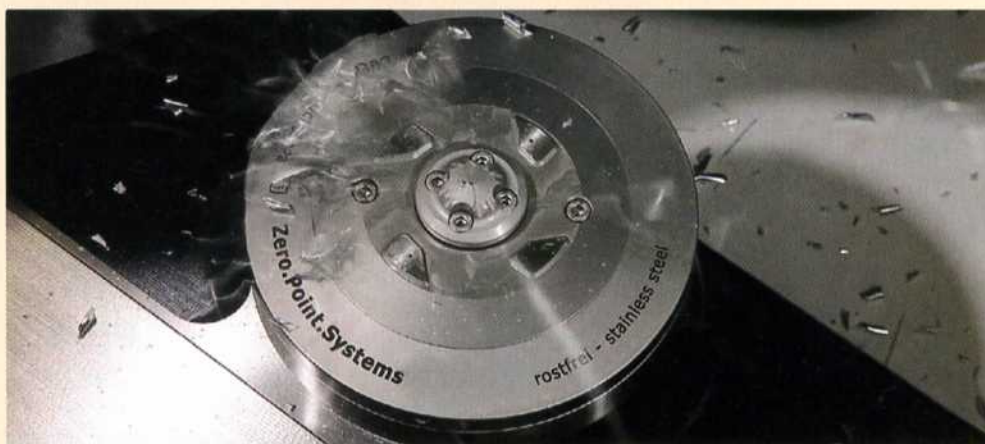
Sobald der Luftdruck einsetzt, dreht sich der verschleißfreie Messingring und bläst alle Späne weg.
