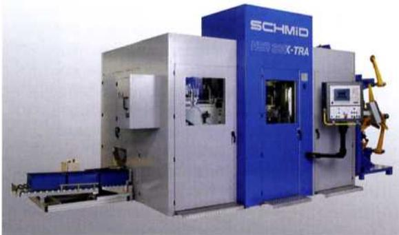
Krafthubs jedem Prozess angepasst werden. Ein im Eilgang durchgeführter Tasthub verkürzt die Zykluszeit genauso wie ein kürzerer Öffnungshub, wenn dünne Teile geschnitten werden sollen. Durch die flexible Geschwindigkeitseinstellung für jeden Schritt lässt sich beispielsweise die Schnittgeschwindigkeit nach langsamem Anschneiden sogar unter Volllast wieder beschleunigen.
