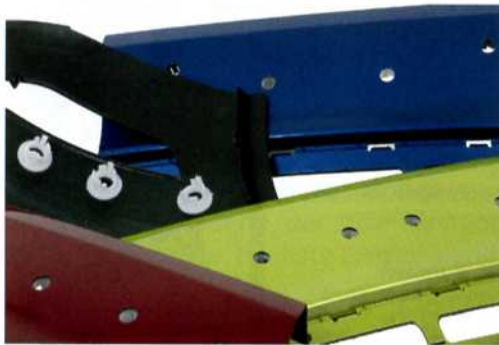
Für das Fügen von Kunststoffteilen für Zusatzfunktionen, wie beispielsweise Abstandssensoren, Kabelclips oder Fixierpins, an lackierten Exterieurteilen im Automobilbau liefert das torsionale Ultraschallschweißverfahren der Telsonic AG beste Ergebnisse.
