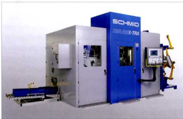
Bild: HSR 320 X-TRA mit energieeffizienter Ringzackenbeschaltung, die 95 % der Energie ins System zurückführt. Zum niedrigen Energieverbrauch kommen weitere Vorteile wie variable Zyklusparameter und verbesserte Teilequalität (Werkbild: Heinrich Schmid AG, CH-Jona)
