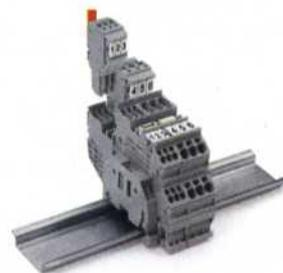
Stecken, ohne Werkzeug. Die Federleisten lassen sich mit einer Verriegelungsklinke gegen versehentliches Abziehen sichern. Sie sind für einen Leiterquerschnitt bis 1,5 mm<sup>2</sup> und einen Nennstrom von 13,5 A ausgelegt.
