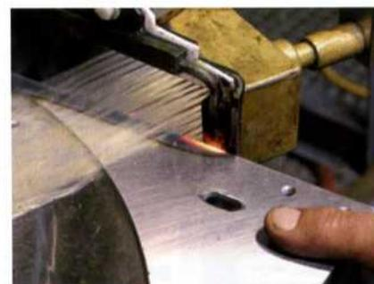
Mit dem neuen Umrichter Statitron IFP können Anwender die Arbeitsfrequenz bei laufendem Prozess stufenlos ändern und so die Wärme bei ein und demselben Werkstück in verschiedene Tiefen einbringen.
