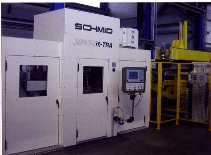
Bild: 700-Tonnen-Feinschneidpresse der Heinrich Schmid AG für Brasilien. Die Neuentwicklung verfügt über den bewährten Servoantrieb des Technologieführers, mit dem Teile bis 17 Millimeter schnell und ohne Schnittschlag feingestanzt werden können (Werkbilder: Heinrich Schmid Maschinen- und Werkzeugbau AG, CH-Jona)
