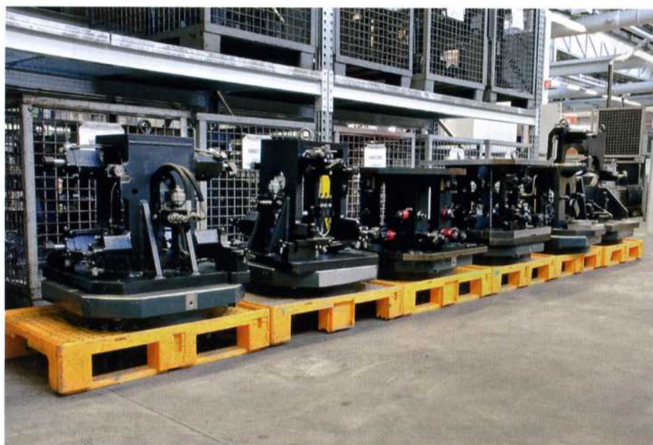
In Wartestellung: Auma-Vorrichtungen auf Grundplatten eines AMF-Nullpunktspannsystems
