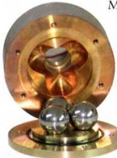
Mit dem magnetisch betätigtes Kugelventil der Rapid Reaction Valve-Technologie (RRV) von GSR Ventiltechnik wird der Durchfluss durch ein Magnetfeld verändert, das die Kugel aus ihrem Ventilsitz herauszieht. Das Ventil reagiert innerhalb von einer Millisekunde auf die Steuerbefehle. (qui)
