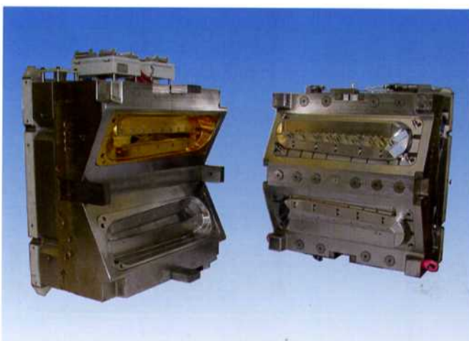
Bild 5: Die Form kann in einem Drehteller-Verfahren gewendet und das Dekorteil nach dem Hinterspritzen auf der Oberfläche beschichtet werden
