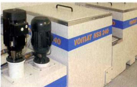
► Instandhaltung: Die Feinstfiltrations-Anlage FA 240 von Vomat trennt im Vollstromverfahren Schmutz- und Sauberöl zu 100%. 35
