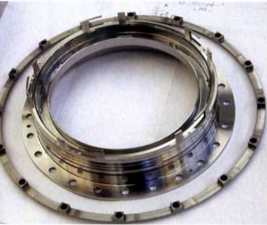
Bild 2: Die metallischen Gleitringdichtungen sind meist aus austenitischen Stählen.
