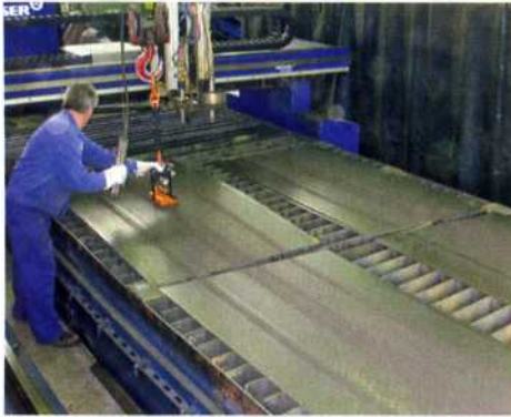
► Trenntechnik: Nach einem Steuerungs-Upgrade ermöglicht es die Funktion Jobliste, vier Bleche gleichzeitig aufzulegen, um sie nacheinander auf der Portalmaschine zu schneiden. 32
