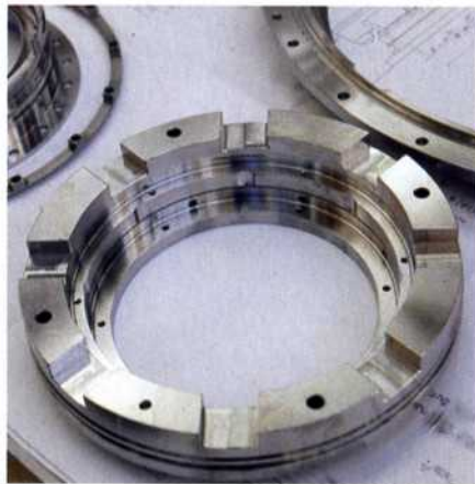
Bild 3: Bei der Bearbeitung der metallischen Gleitringdichtungen ist eine mikrometeregenaue Fräsbearbeitung unabdingbar.
