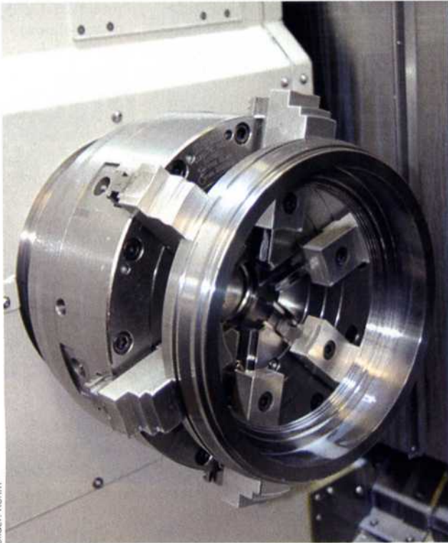
Bild 4: Die dünnwandigen und leicht verformbaren Werkstücke werden mit sechs Backen und einer maximalen Kraft von 150 kN sicher und formstabil gespannt.
