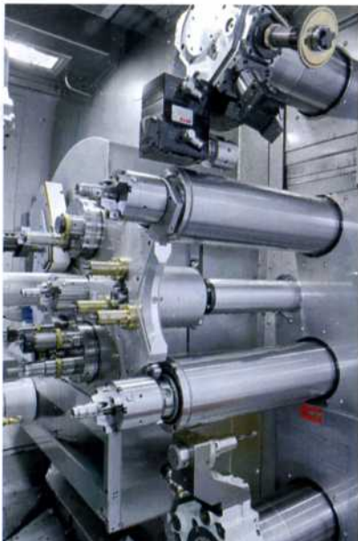
Bild 4: Die Wechseinheit zwischen den drei Spindeln für die Rückseitenbearbeitung wechselt Werkstück samt Spannfutter und HSK-Aufnahme
