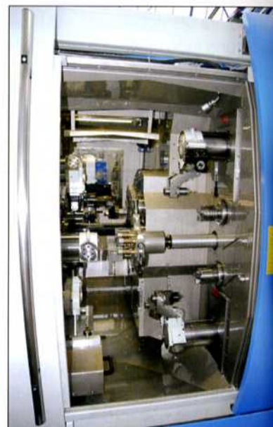
Bild 2: Die SCX-Maschinen von Schütte verfügen über einen ungewöhnlich freien Arbeitsraum, aus dem alles verbannt wurde, was nicht direkt an der Entstehung des Werkstücks beteiligt ist
