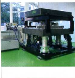
Das AIS dient als Schwingungs-Isolierungssystem.
